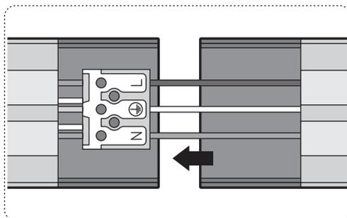
Произвести подключение следующего светильника в линии:
