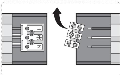
Снять винтовую колодку с магистральных проводов
