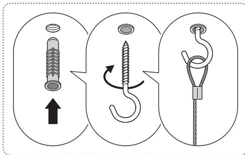
**2** Закрепить шуруп-полукольцо на поверхности потолка. Зацепить трос за шуруп-полукольцо
