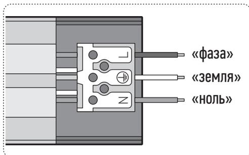
Подключить питающий провод в соответствии с маркировкой на клеммной колодке:
