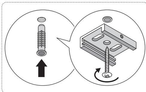
**2** Закрепить на поверхности потолка скобы крепления
